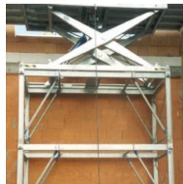
Für Mauerbühnen über 5 m können beide Mauerbühnen mit bis zu 2 klappbaren Untergerüsten unterbaut werden. Einfach aufklappen, sichern, und für die Mauerbühne 3000 die Untergerüstverlängerung anbauen. Damit sind Mauerhöhen bis ca. 8 m ohne Reduzierung der Bühnenlast möglich.
