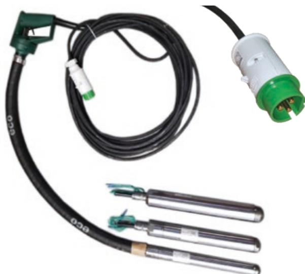
Stockrüttler können an alle Umformer mit 42-50 V / 200 Hz angeschlossen werden. Dreifache Kugellagerung, gehärteter Rüttelkopf und Rohr, sowie Thermoschutz in der Wicklung und erstklassige Verarbeitung garantieren ausgezeichnete Leistung und lange Lebensdauer.
