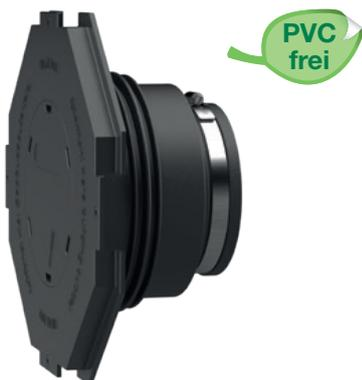
Lieferumfang: Gummimanschette (EPDM) mit Anspachtelflansch mit Blinddeckel zum Einschlagen, Stahlspannband und Lamellenstopfen, passend für KG Rohre und KG-2000 Rohre, MPA geprüft, vorort auf Wandstärke anpassbar. Die Länge des KG-Rohres muss der Gesamtbaulänge der Durchführung, also der Wanddicke minus 6 mm entsprechen. Keine Unterbrechung der Fließrichtung.
