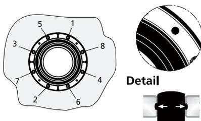
Schrauben im Uhrzeigersinn kreuzweise anziehen bis ein Drehmoment von 5 Nm erreicht ist oder mit dem Schlüssel die Rohrdichtung gleichmäßig anziehen bis der Gummi aus allen Kontrollbohrungen heraustritt.
