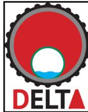
Der VPC DELTA Ring besteht aus einem äußerst widerstandsfähigen Elastomere-Material und besitzt - je nach Größe bzw. Anwendungsfall - eine statische Aussteifung. Der DELTA Ring ist in der VPC-Kupplung **verliersicher eingelegt** und in dieser **360° drehbar**.
